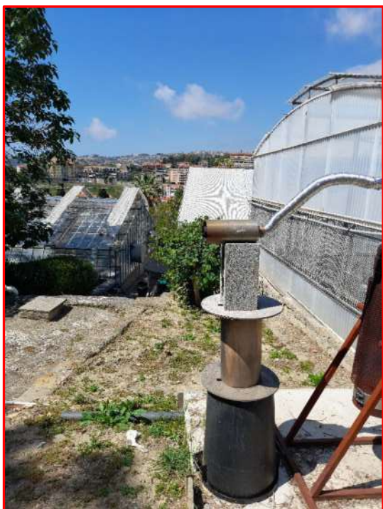
Gasogeno Tecnoforest in funzione al 40% della potenza (circa 120 kW, foto a sinistra) e a piena potenza (circa 280 kW, foto qui sopra).
