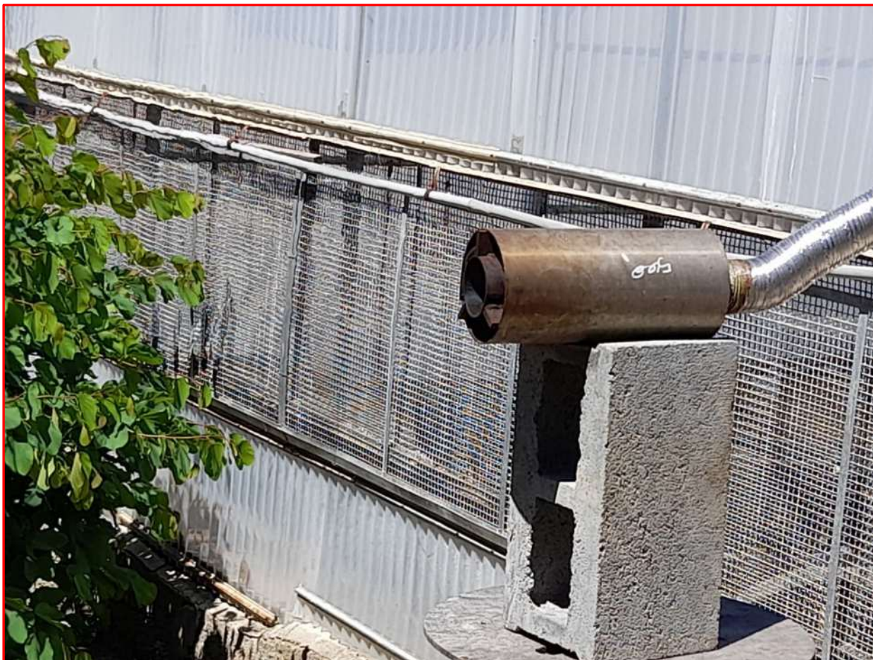
Gasogeno Tecnoforest: bruciatore premiscelato per la combustione del syngas
