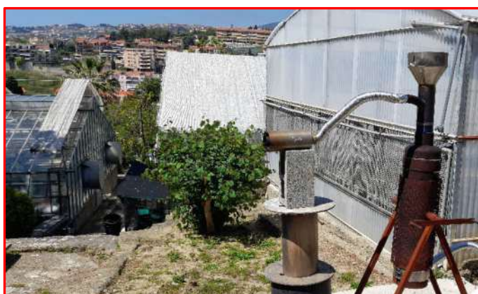
Gasogeno Tecnoforest in funzione al 40% della potenza (circa 120 kW, foto a sinistra) e a piena potenza (circa 280 kW, foto qui sopra).
