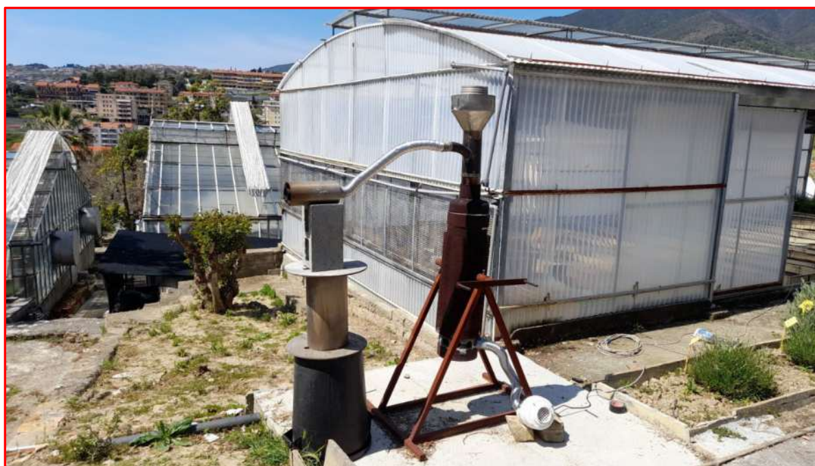
Gasogeno Tecnoforest SynBurner atto alla produzione continua di energia termica. Vista d'insieme dell'impianto montato sulla piazzuola dedicata presso CREA
