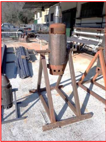
Gasogeno SynChar nell'officina Tecnoforest e al primo montaggio presso CREA
