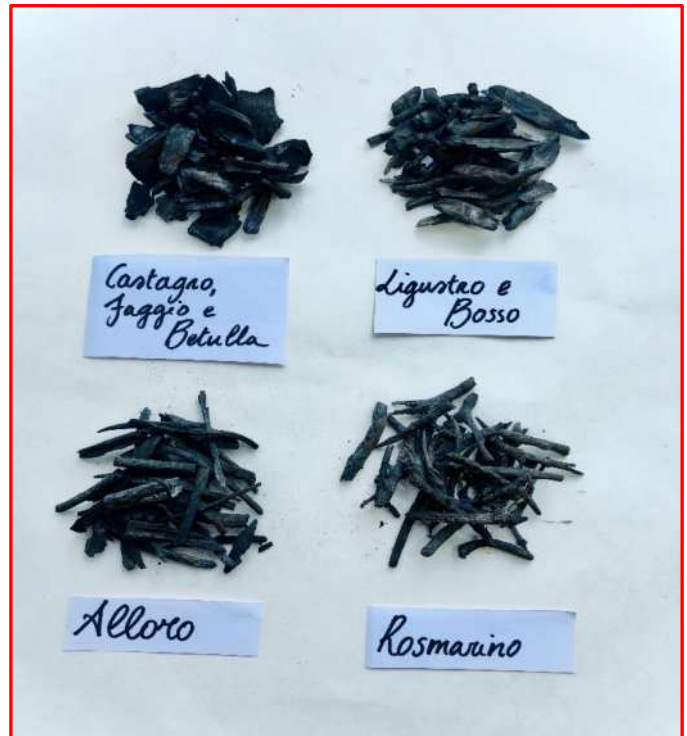
Biochar da cippato legnoso e da trinciati arbustivi prodotti presso CREA
