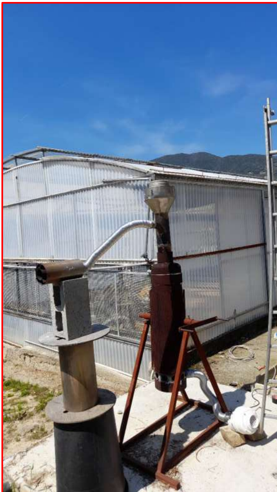
Gasogeno Tecnoforest: in basso a destra notare la soffiante dell'aria di processo
