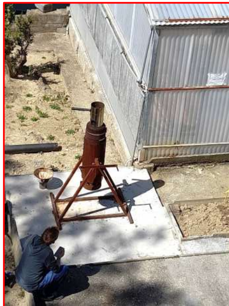
Gasogeno SynChar nell'officina Tecnoforest e al primo montaggio presso CREA
