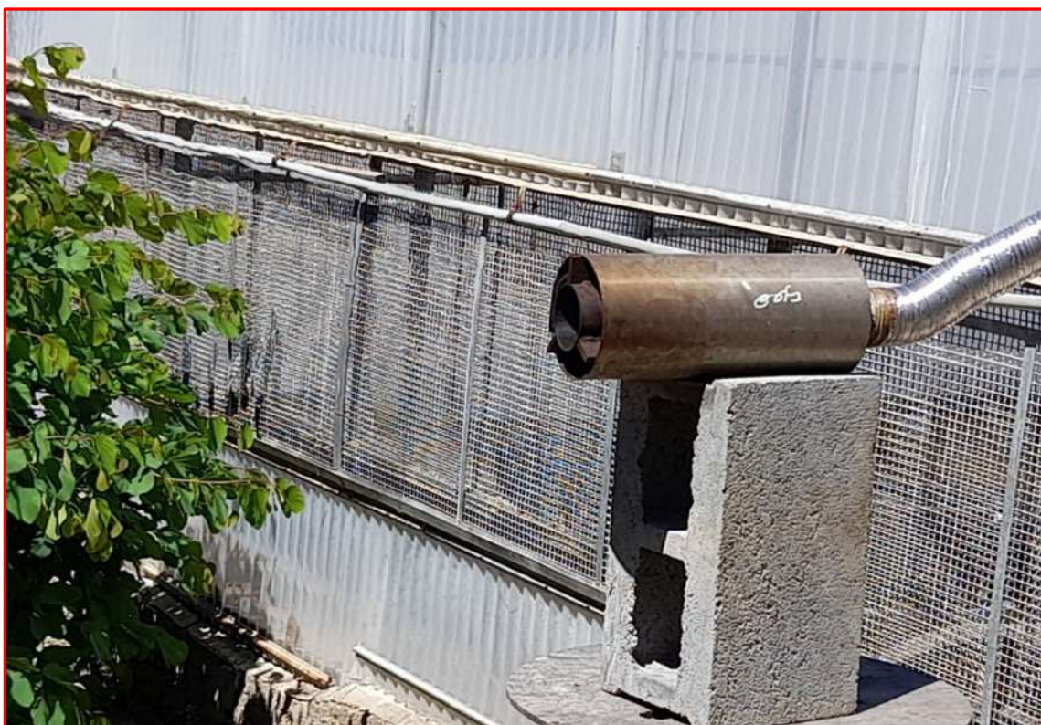
Bruciatore premiscelato per la combustione del syngas
