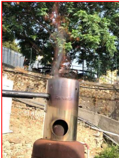
Gasogeno SynChar in funzionamento presso CREA. Notare la pulizia della fiamma.
