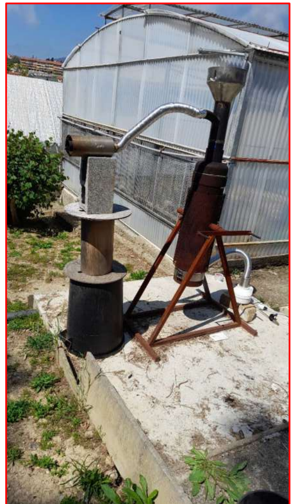
Gasogeno Tecnoforest: notare la tramoggia di carico del cippato in alto a destra
