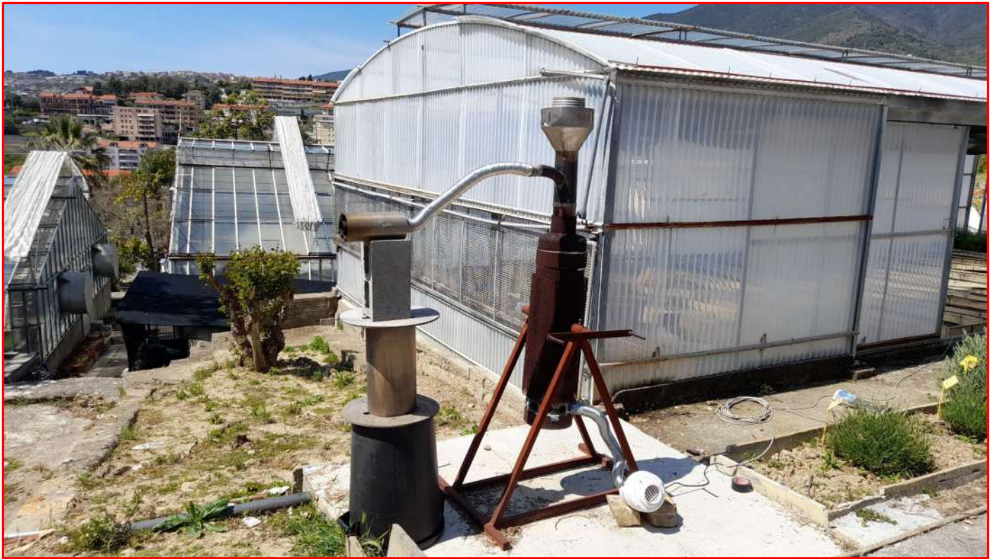
Gasogeno Tecnoforest convertito alla produzione continua di energia termica. Vista d'assieme dell'impianto montato sulla piazzuola dedicata presso CREA
